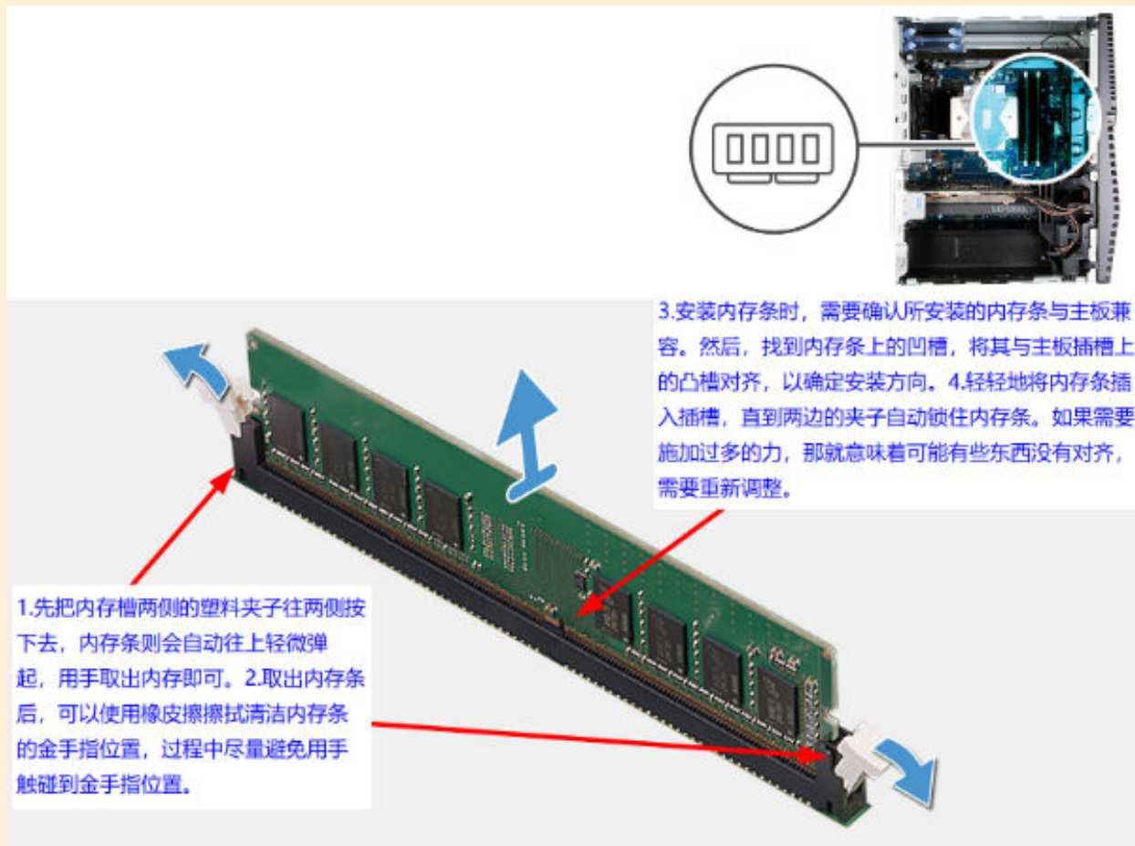
图4.4 拆卸和安装内存条的方法
