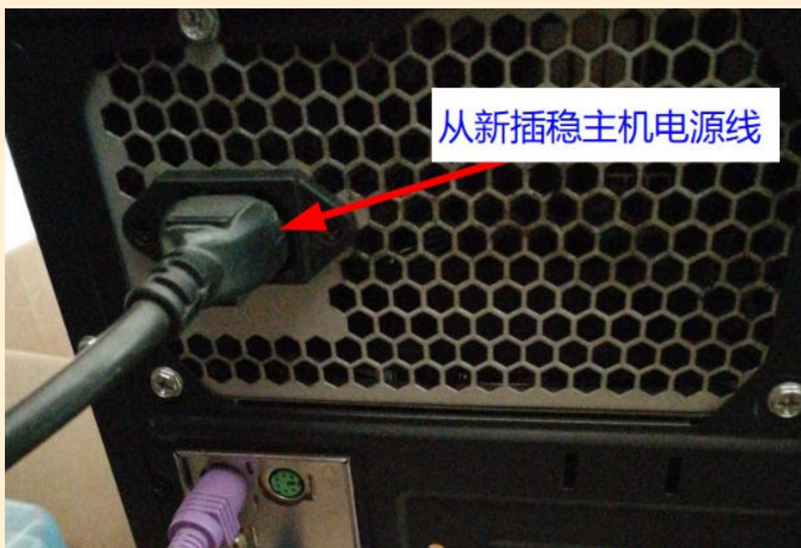
图1.2重新插稳电源线或更换一条电源线测试
