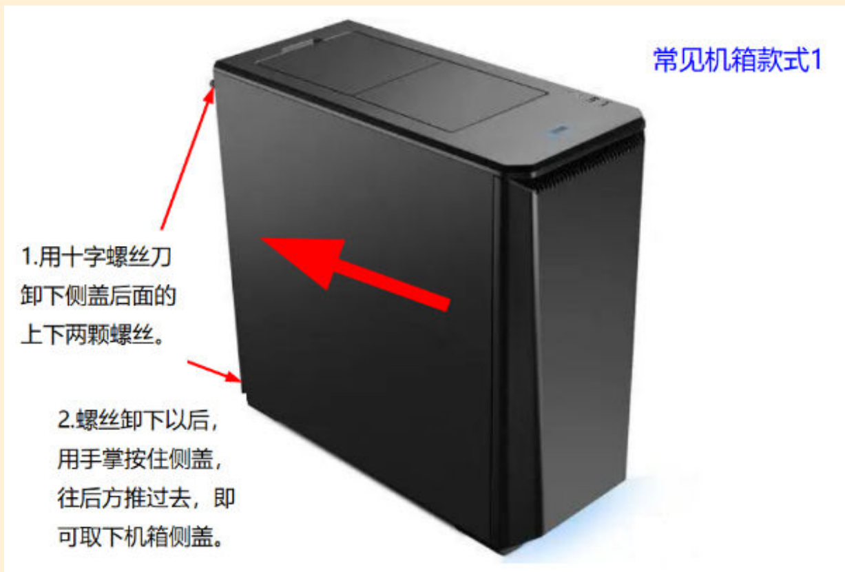
图4.1 打开主机机箱边盖的方法
