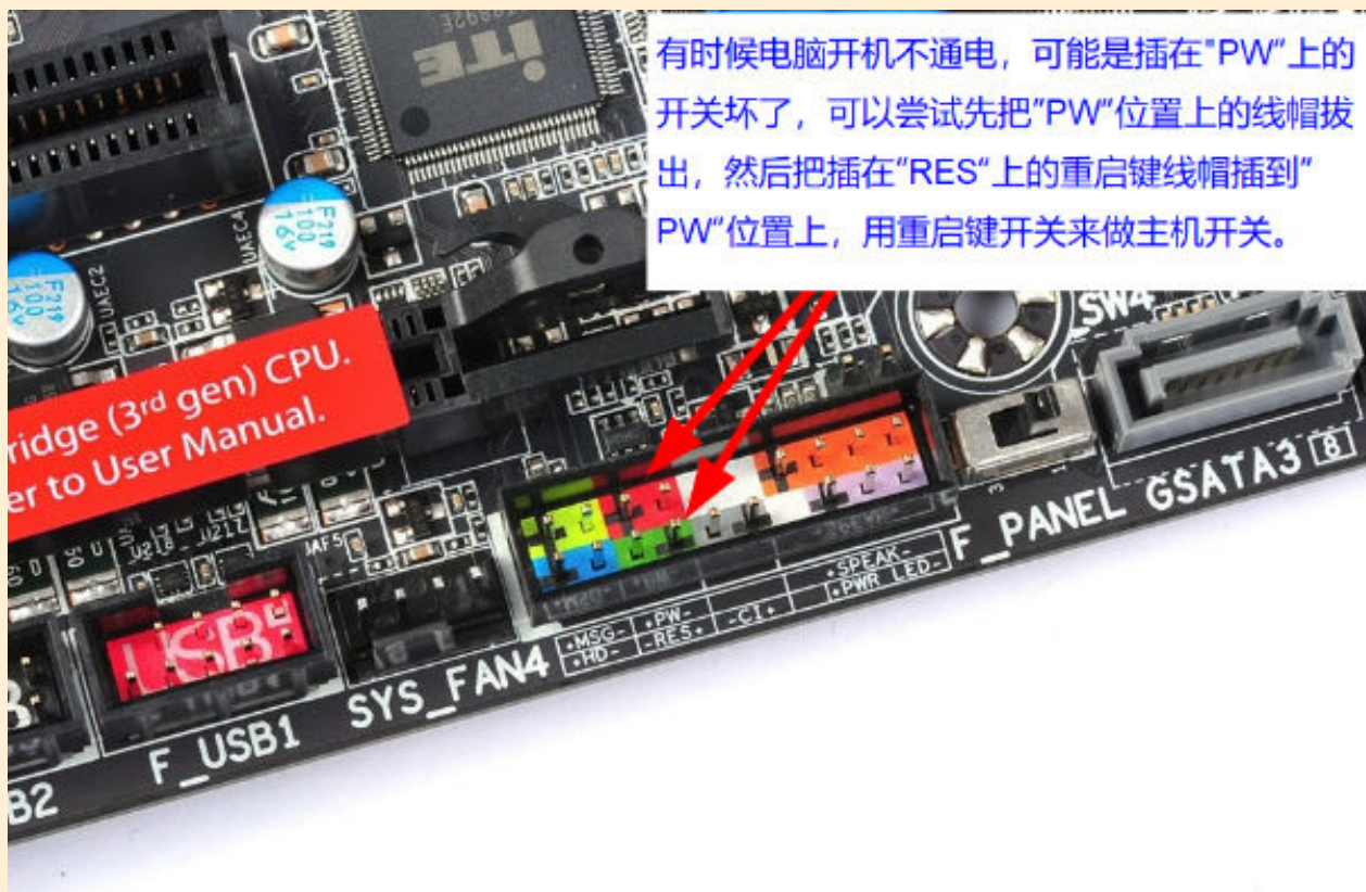
图2.2 使用重启键开关来代替主电源开关的方法
