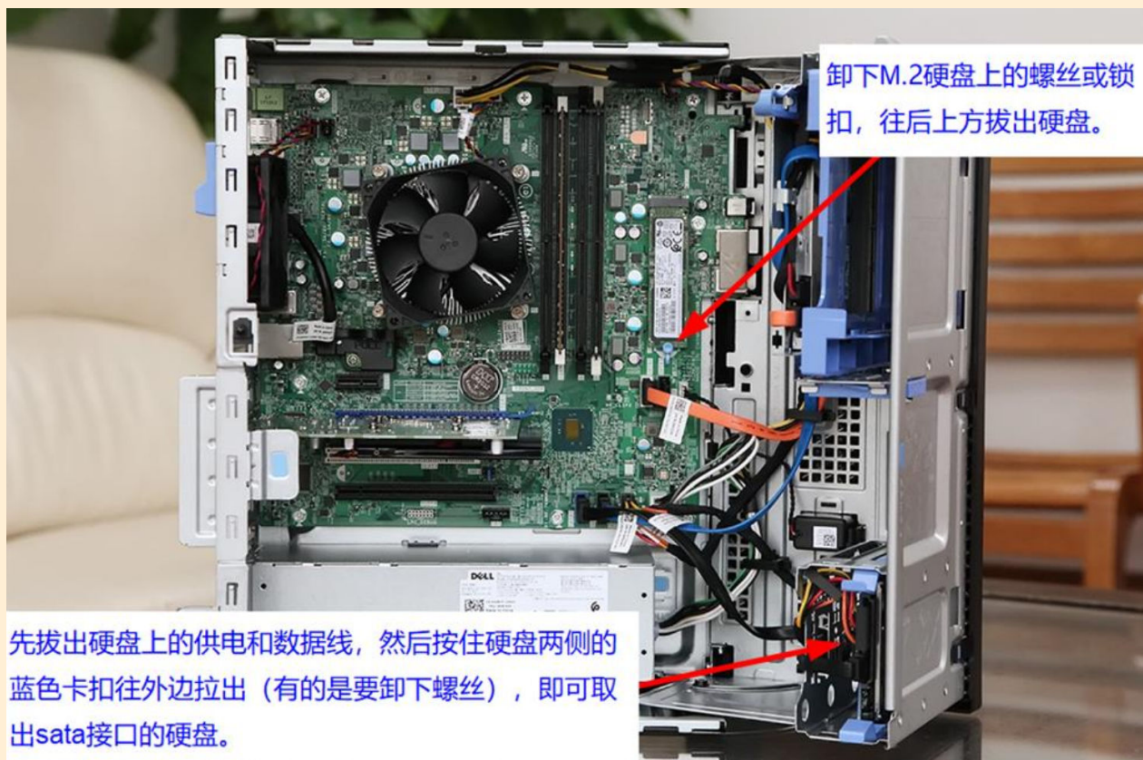
图9.2品牌台式机拆卸硬盘的方法
