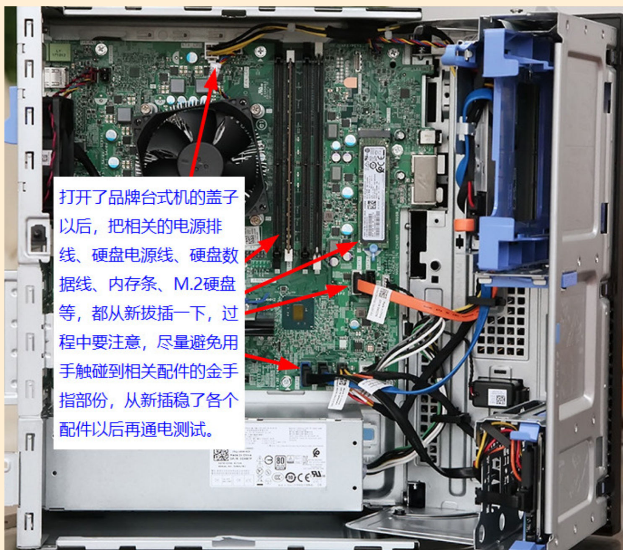
图6.2品牌台式机拔插主机内各种接口排线。
