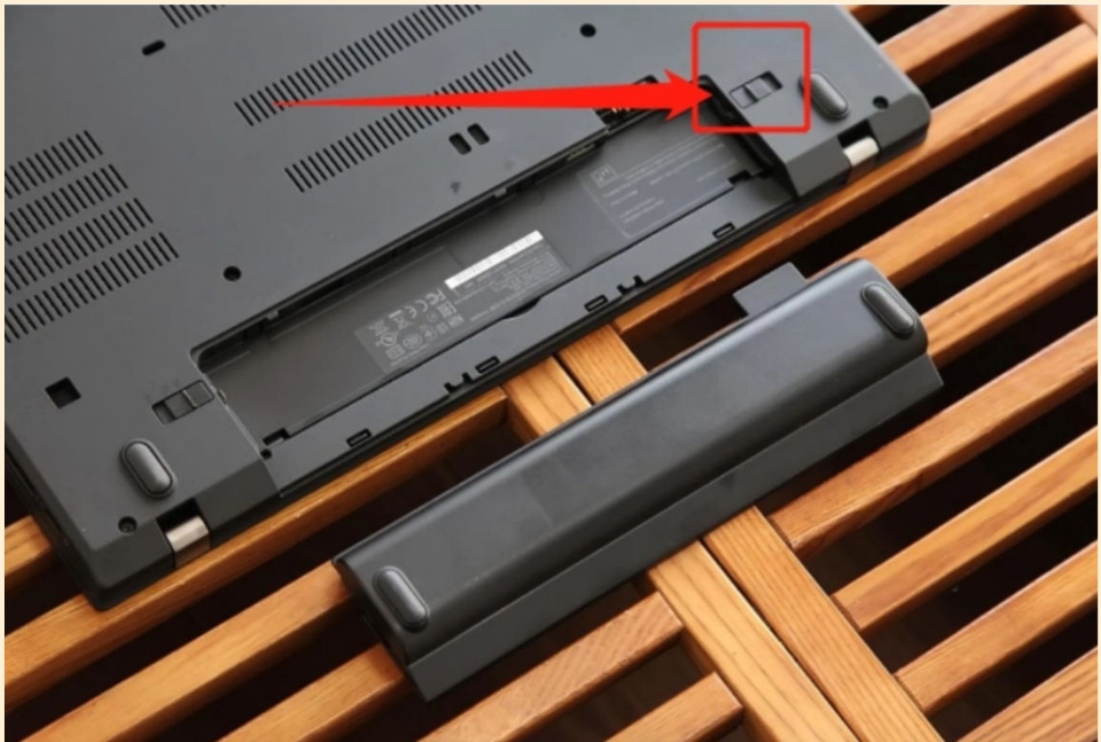
图13.4 外置式电池笔记本的拆卸方法
