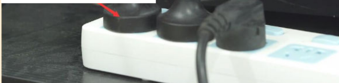
图1.1 检查电源排插是否已正常通电，排插插孔所对应的开关是否已经打开，连接电脑主机的电源线是否已经插稳
