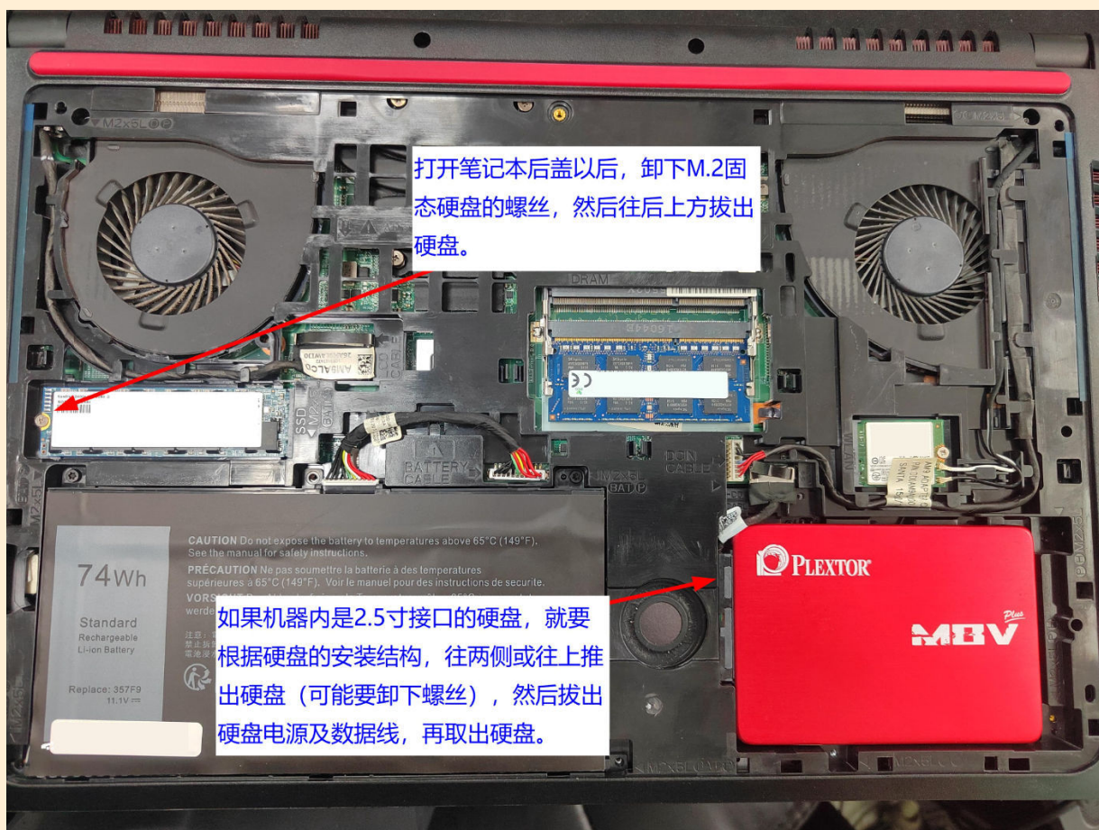
图18.1 笔记本拆卸硬盘的方法，安装方法则是反向操作。
