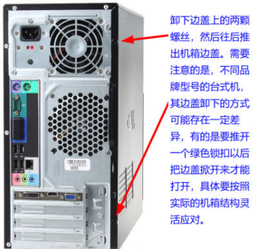
图4.3 品牌台式机打开主机机箱边盖的方法
