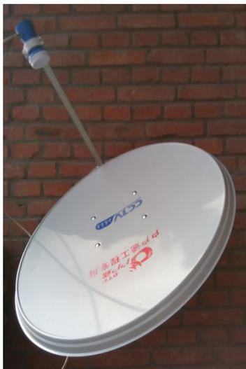
小结：室外安装注意防水排水，高频头用矿泉水瓶套上，象这种卧式锅挂墙要在底座最低点打一个排水孔。
