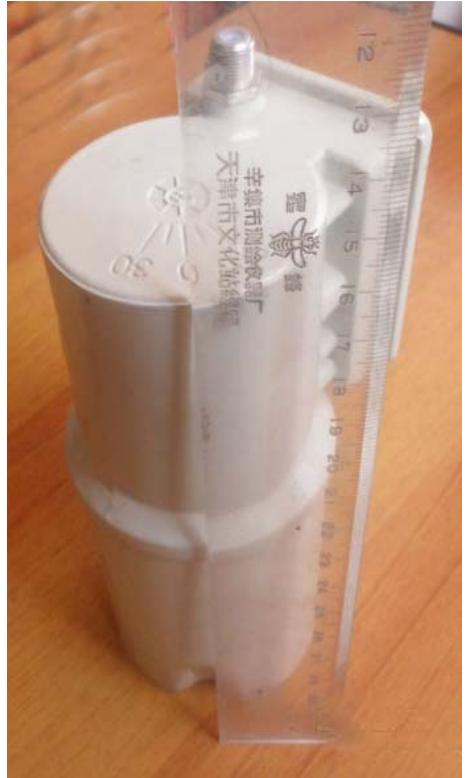
4、**类复合头的制作：**以上准备工作做完后，类复合头的制作也就简单了，也就是用夹具将两个星的高频头固定在一起就可以了。固定的方法：就是将接收韩星 5A 号的 KU 波段高频头用改制好的夹具固定在 C 头的东边。使 KU 头的波导管和 C 头下部边缘的浅坑对齐紧靠，按经验将 KU 头的极化角调好。KU 波段铁质高频头在调试过程中，F 头通常指向七点半的时候为水平，指向四点半的时候为垂直。也有例外，有的 KU 波段塑料高频头 F 头通常指向六点和十二点的时候为垂直，指向三点和九点的时候为水平。类复合头在家里提前制作好，到安装一锅双星的时候直接拿去使用就可以了。
