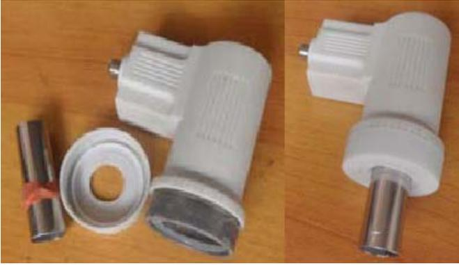
KU 波段铁质高频头加波导管就更简单，用22MM 粗的波导管，直接插到高频头就可以了。为了牢固，也应该将盖在中间烫个孔，然后将盖抠下来，在7 厘米长的波导管上套上一个胶圈，可以在废自行车内胎上剪一个胶圈，绕一圈套在22MM 粗7厘米长的波导管上，让胶圈卡在盖的里面，波导管就固定的更牢固了。如果卡结实了，也可以不加盖。如果高频头插波导管的孔较大，可以在波导管上缠一圈胶布，使波导管固定的更牢固。
