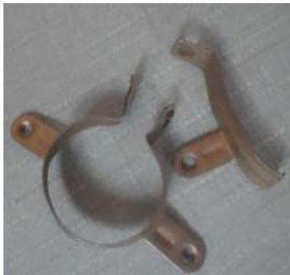
第二种方法不是太正规，但更简单，同样实用，效果相同：就是将固定 C 头的铁夹先套在 KU 头上，在开口处穿上螺丝，留一厘米的开口，然后用手将多余部分捏起来，再用尖嘴钳子弯平，改制就算完成了。
