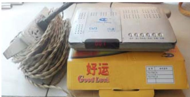
在城市的楼房上插电拔电不太方便，用一块小型电池（45元），配一个逆变器（55元）一个接头（5元），再配一个充电器，总共下来120元左右。再用薄塑料板或薄木板做一个内边18厘米长、10厘米宽、12厘米高的小箱子，将以上配件组装在木箱里，就可以方便的使用了。
