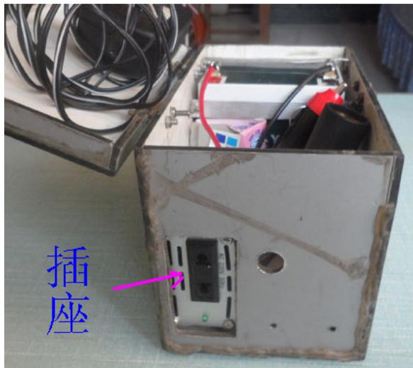
如果做小箱子不方便的话，可以将小型电池和逆变器用胶带固定在一起，将插座冲上方，然后用旧包装上提着也很方便。
