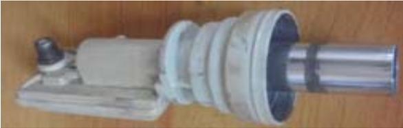
KU 波段铁质高频头加 19MM 的波导管也可以，就是将插入高频头一端的波管用胶布绕几圈加粗。
