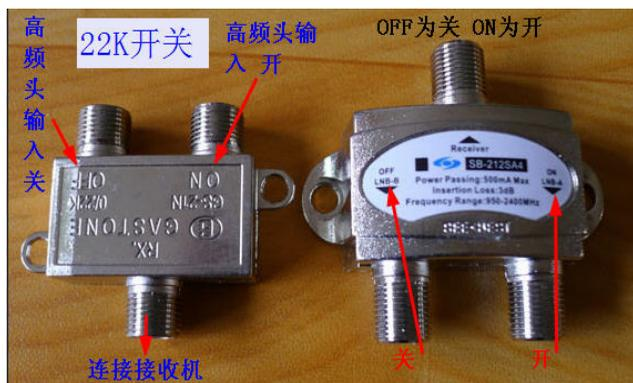
如果 KU 高频头是双本振的（本振频率 10600，标签上一般为 9750MHz、10600MHz。）22K 开关接开，中星 6B 接关；如果 KU 高频头是单本振的（本振频率 11300，标签上一般为 11300MHz 或 11.3GHz。）22K 开关接关和开都可以，如果 KU 头接关，中星 6B 接开，如果 KU 头接开，中星 6B 接关；如果 KU 高频头双本振是 9.75/10.75GHz 的，本振频率输入 10750；22K 开关设为关。中星 6 B 接开。
