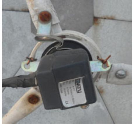
第二种方法就是用60CM偏馈锅自带的馈源夹和中九锅上的馈源夹直接固定在正馈锅上。有的中九小锅馈源夹没有没有现成的孔，可以用合适粗的铁棍加热烫一个孔。
