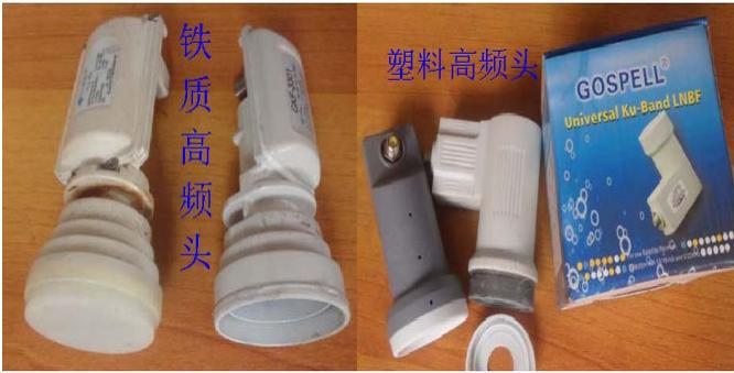
**1: KU 高频头的认识:** 接收韩星5A号新唐人需要用到KU 波段高频头。KU 波段高频头有单本振和双本振之分，经常用到的单本振高频头本振频率为11300 ， 双本振高频头本振频率为10600。KU 波段高频头有铁质高频头、铝壳高频头和塑料高频头。本一锅双星使用哪种KU 波段高频头都可以。铁质高频头和铝壳高频头插波导管比较方便，但价格较贵，塑料高频头相对价格便宜一些。本教程的塑料高频头加波导管的简易方法，供大家参考。
