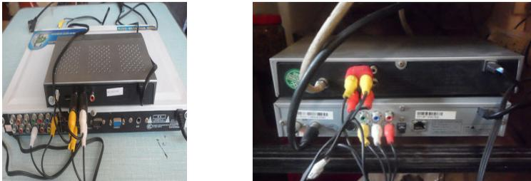
**串联方法：**如果卫星接收机连着电视，在卫星接收机音视频端口上插上两个音视频分线插头，将DVD机音视频线插在分出的插头上，其余类推。
