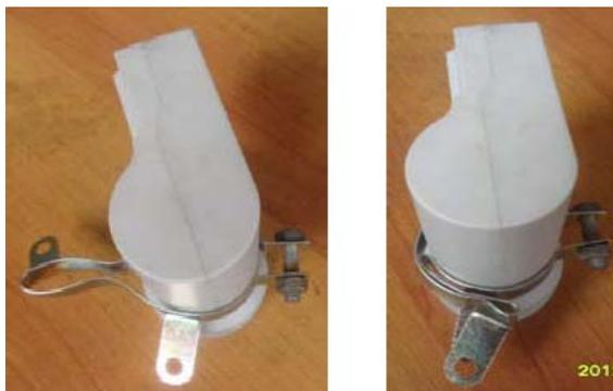
改制的双星夹具使用起来也很方便，可以调节两头之间的夹角，如果 KU 头直径较大，需要夹角大些时，只要将拧竖起来的那个爪，用钳子向外掰一下就可以了，反之，用钳子向里掰一下就可以了。两头夹角轻微调节一下，不影响接收效果。
