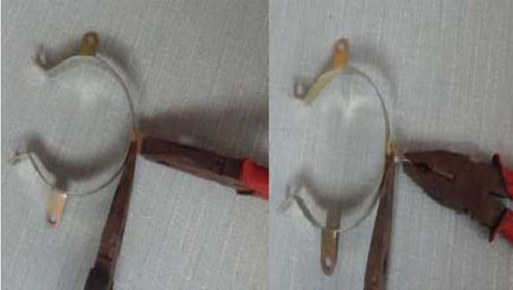
**KU头夹具的改制有两种方法：**一种比较正规的改制方法，就是将固定C头的铁夹多余部分用钳子弯断，再用钻头在弯断的头部打一个相同的眼。
