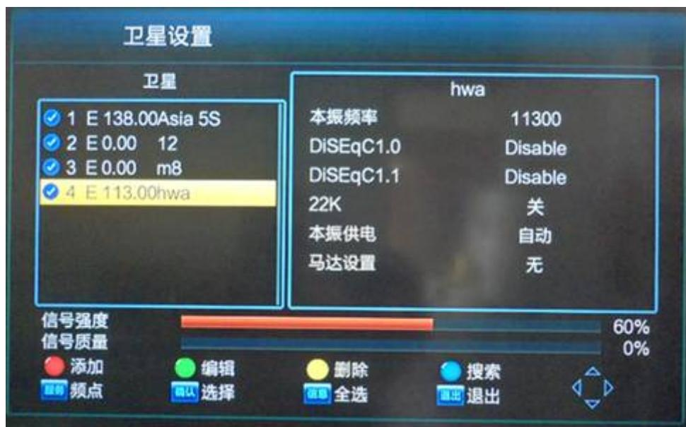
按遥控器上的蓝色键到搜索界面：用遥控器上的左右键设置如下：
