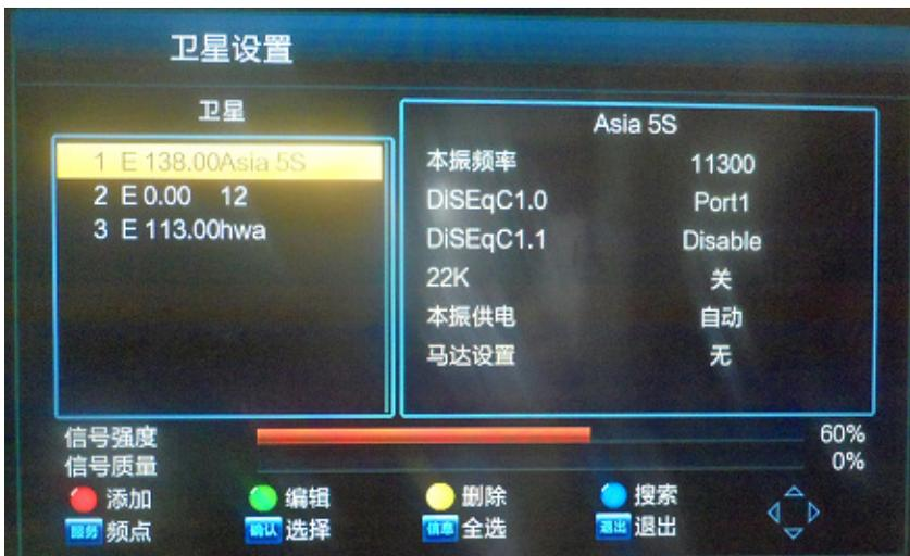
我们选中 138 亚五卫星，按照界面提示，按遥控器上的**服务**（有的是**F3**）键，切换到频点编辑界面，如果发现右边框中卫星设置不符合要求，可用右行键到设置框中，参考前面的章节设置：
