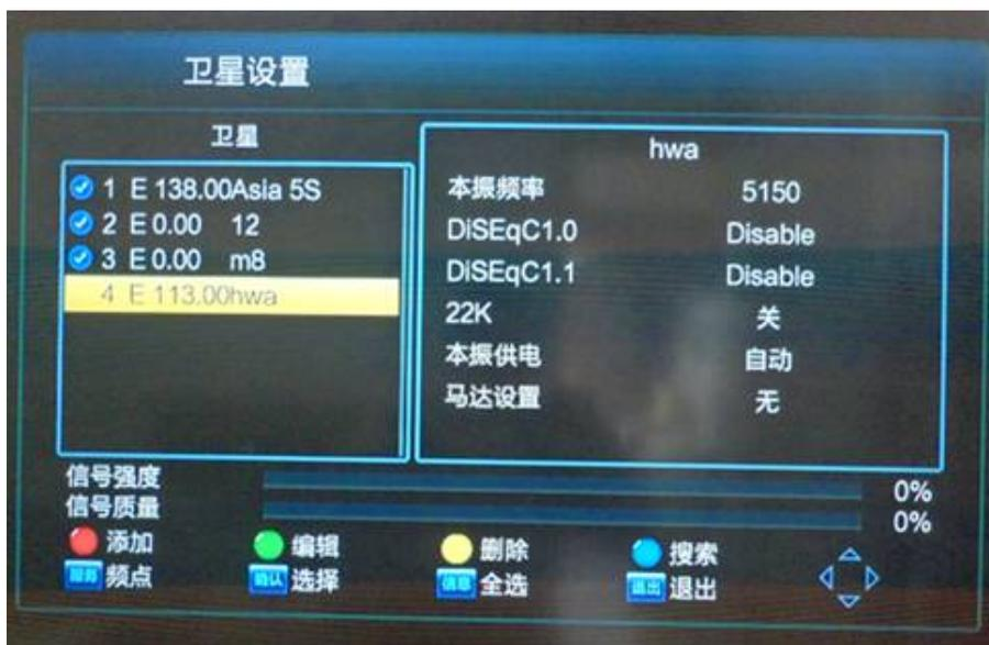
下面设置一下新建卫星的本振频率和 22K: 如果本振频率是 10600, 22K 设置为开; 如果本振频率是 11300 或 10750, 22K 设置为开或关都可以。按遥控器上的右行键, 进入卫星设置框, 设置本振频率和 22K, 其它的不用管。按确认键在下拉菜单中选择适合的本振频率, 按左右键依次选择适合的本振频率。
