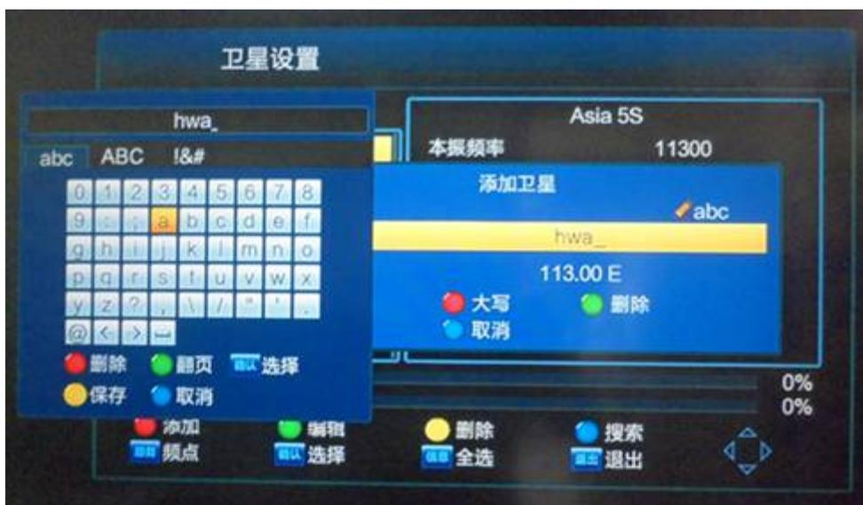
这里的名称输入 hwa，经度输入 113，输入完后，按遥控器上的黄色键确认保存。
