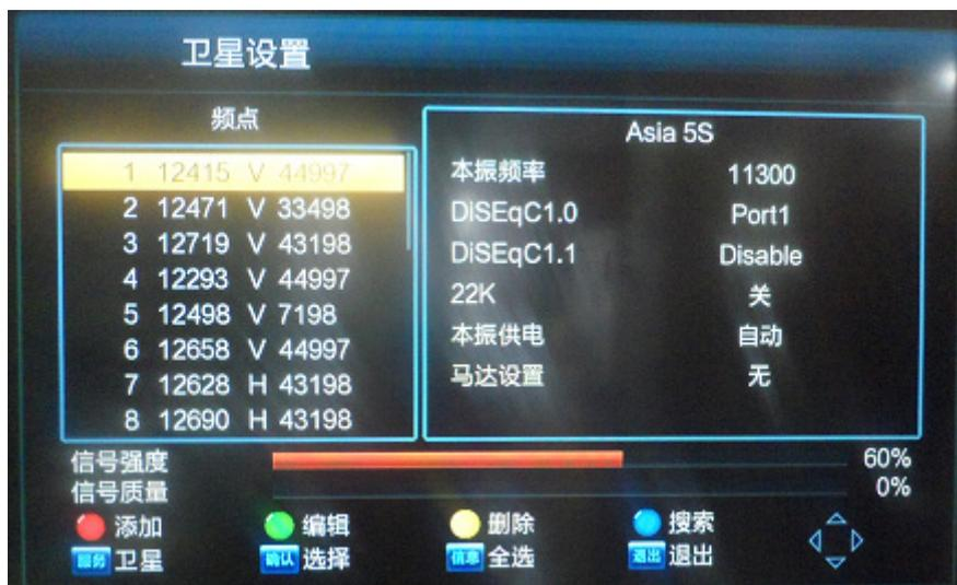
选中一个合适的频点，按界面提示，按绿色键编辑频点。光标移到频率或符号率，按确认键后就可输入参数了，输入完成后按确认键就可以了。
